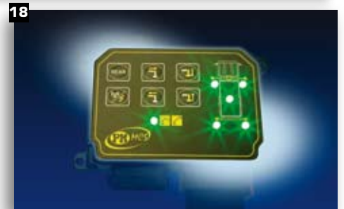
18 MCS: sistema di stabilizzazione azionato tramite pulsantiera bilaterale a membrana o tramite radiocomando, in grado di movimentare gli stabilizzatori anteriori e quelli supplementari.
